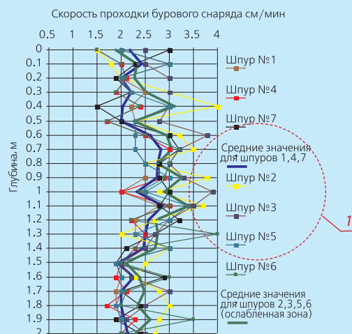
Рис. 3. Графики скорости проходки бурового снаряда: 1 — ослабленная зона в бутовой кладке фундаментов (повышенная скорость проходки)
