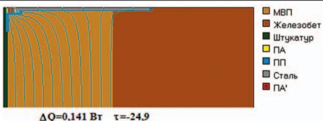
Рис. 2. Температурное поле узла прохождения дюбеля.
