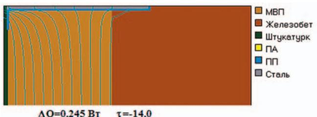
Рис. 3. Температурное поле узла прохождения дюбеля.
