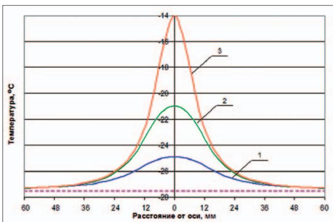
Рис. 4. Распределение температуры по поверхности штукатурки в зависимости от расстояния до оси дюбеля. 1, 2, 3 соответствуют вариантам дюбеля на рисунке 1.
