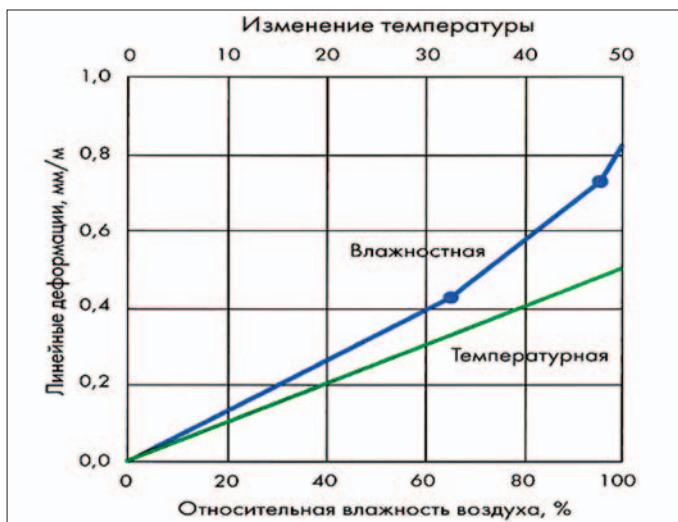
Рис. 7. Зависимости линейной деформации штукатурки от влажности и изменения температуры (рисунок из статьи [1])
