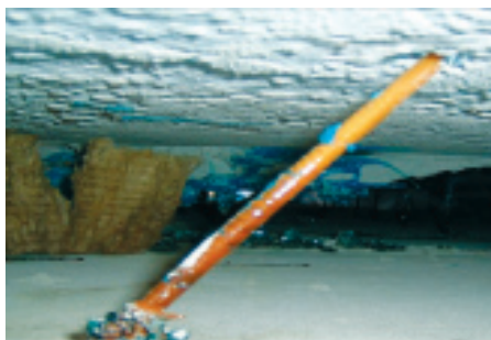
Фото 3. Гибкая связь СПА® Ø 7,5 мм в ленточной панели после пожарных испытаний
