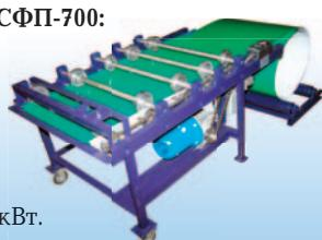
Станок поставляется в комплекте с разматывателем рулона, дополнительно оснащается дисковым ножом попечной резки, комплектами роликов для формирования ребер жесткости «трапеция» или «полукруг».
