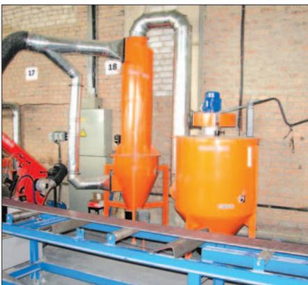
Все более широкое применение в последние годы находят циклоны с центральным закрученным потоком, позволяющие лучше использовать весь рабочий объем пылеулавливающего аппарата и в, конечном счете, повысить эффективность улавливания.
