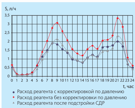
Рис. 6. Суточный график дозирования реагента (ЦТП жилого микрорайона)
