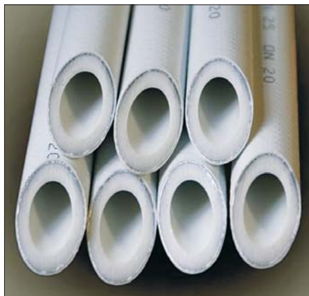
Фото 1. Полипропиленовые трубы, армированные перфорированной алюминиевой фольгой с внешнего края трубы
