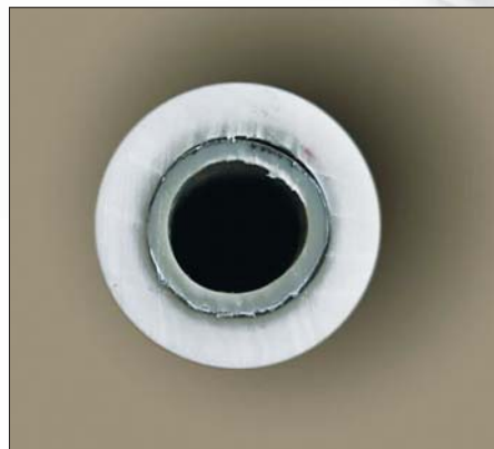
Фото 6. Незаторцованная труба (налицо физическая деградация и расслоение, как результат — протечки и растрескивания)
