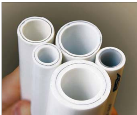
Фото 2. Полипропиленовые трубы с алюминиевым слоем, расположенным посередине или ближе к внутреннему краю трубы (у разных производителей толщины стенок труб одинакового диаметра различны)
