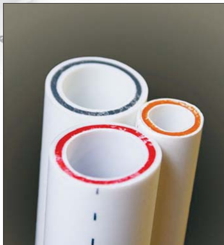
Фото 10. Цвет стекловолокна в полипропиленовых трубах не имеет значения и не влияет на качество продукции, это своеобразный маркер, позволяющий сохodu узнавать продукцию определенного производителя
