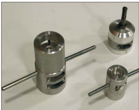
Фото 7. Эти инструменты компании «Эгопласт» используются для зачистки полипропиленовых труб, армированных алюминием: насадка на перфоратор, универсальный зачистной инструмент для четырех типоразмеров труб и стандартный зачистной инструмент на два типоразмера
