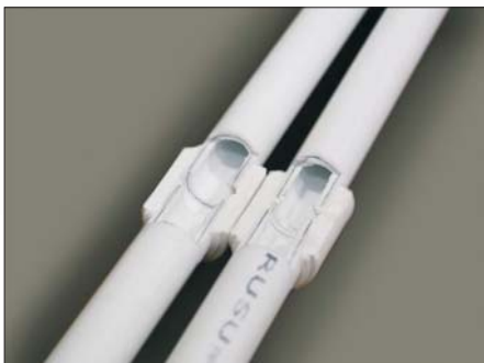
Фото 5. Перед вами две трубы: одна из них (правая) перед соединением с фитингом была зачищена (фольга заплавлена, контакта алюминия с водой не будет), другая (левая) — не была зачищена
