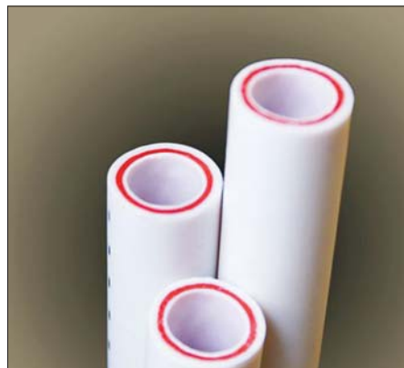
Фото 8 и 9. Rubis Fiber Glass — трехслойные трубы PP-R, армированные стекловолокном (продукция призвана облегчить труд монтажников, значительно ускорить монтаж и обеспечить экономию материала). Области применения: отопление, кондиционирование, системы технического и питьевого водоснабжения
