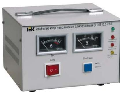
**Отсутствие помех.** В стабилизаторах электромеханического типа отсутствуют помехи при работе, не происходит искажения синусоидальной формы напряжения. В стабилизаторах релейного типа форма выходного напряжения также синусоидальная, но присутствует ее прерывание при переключении обмоток трансформатора. В стабилизаторах напряжения тиристорного типа происходит искажение синусоиды и образование помех, которые нарушают работоспособность видео- и радиоаппаратуры.
