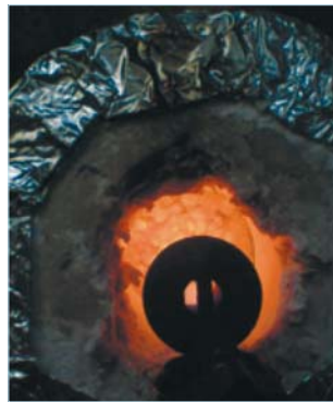
Фото 4. Испытания образцов защитных покрытий на способность к вспучиванию после искусственного старения
