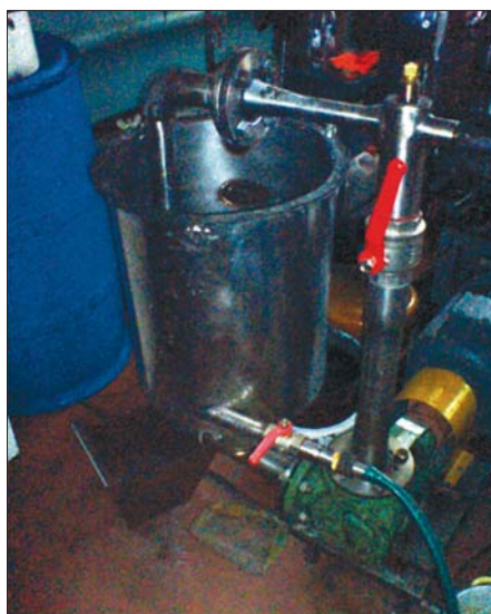
Фото 2, 3. Вид роторного аппарата (РАМП) в натуральную величину
