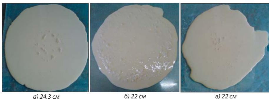
Фото 3. Вязкость ( \nu , см) огнезащитных вспучивающихся композиций по Суттарду: составы а) — №1, б) — №2, в) — №3
