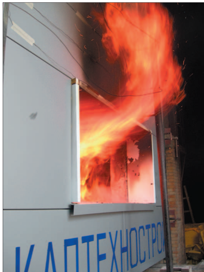
Фото 2. Общий вид образца фасадной системы в момент проведения огневых испытаний — на 10 минуте с момента достижения температуры, фиксируемой ТЭП №1, = 120 °С
