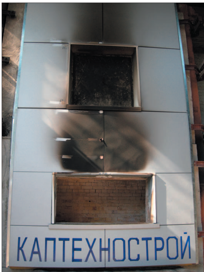
Фото 3. Общий вид после испытаний образца фасадной системы «Каптехнострой» типа КТС-КХ-ХХ-ВХ (КТС-4)
