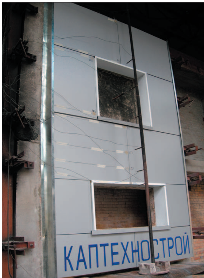
Фото 1. Общий вид перед испытаниями образца навесной фасадной системы «Каптехнострой» типа КТС-КХ-ХХ-ВХ (КТС-4) с воздушным зазором, двухслойным стекловолоконным утеплителем, каркасом из алюминиевых профилей, облицовкой основной плоскости кассетами, выполненными из композитного материала GOLDSTAR FR, и облицовкой откосов оконных проемов стальными панелями производства компании ЗАО ИСК «Каптехнострой», смонтированного на фрагменте железобетонной стены
