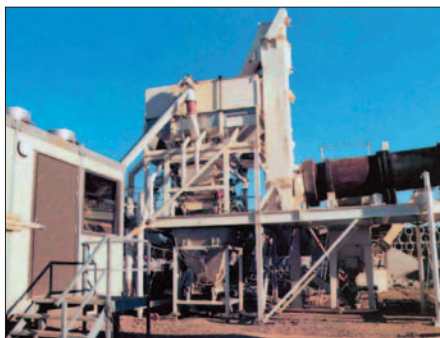
Оборудование для изготовления серного бетона (Дания)
