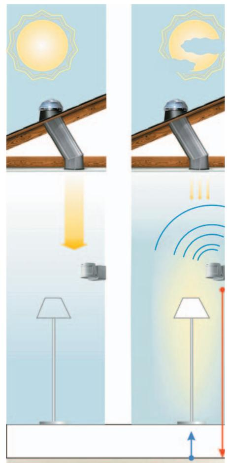
Рис. 2. «Гибридная» система освещения
