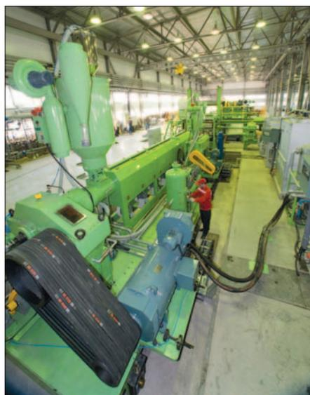
Завод «КРАСПАН». Высокотехнологичная линия по производству огнестойких АКП Краспан-AL. Сердечник огнестойкой фасадной панели Краспан-AL на 75% (в перспективе – до 85%) состоит из минералов – этого позволяет добиться мощный экструдер новой линии завода «КРАСПАН», аналога которой нет в России.
