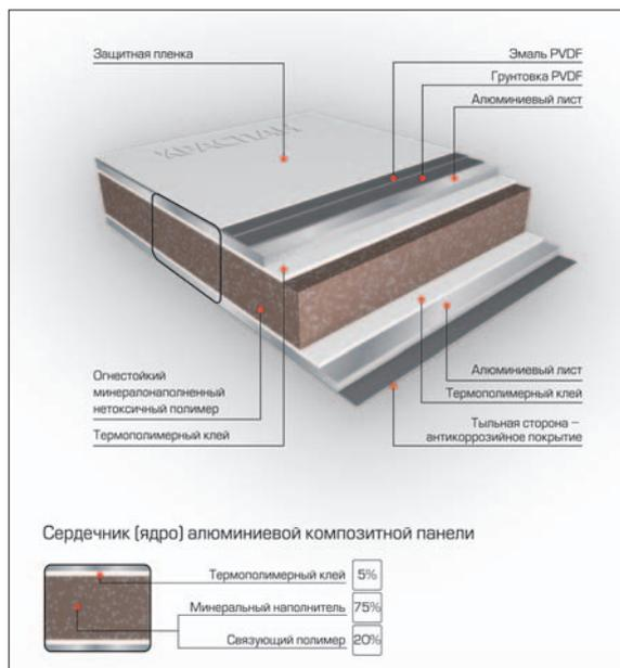
Огнестойкость алюминиевой композитной панели зависит от состава сердечника, а именно от того, сколько процентов минеральной составляющей находится в среднем слое. При производстве панелей Краспан-AL применяется технология, которая дает возможность наполнить сердечник минералами на 70-85%.
