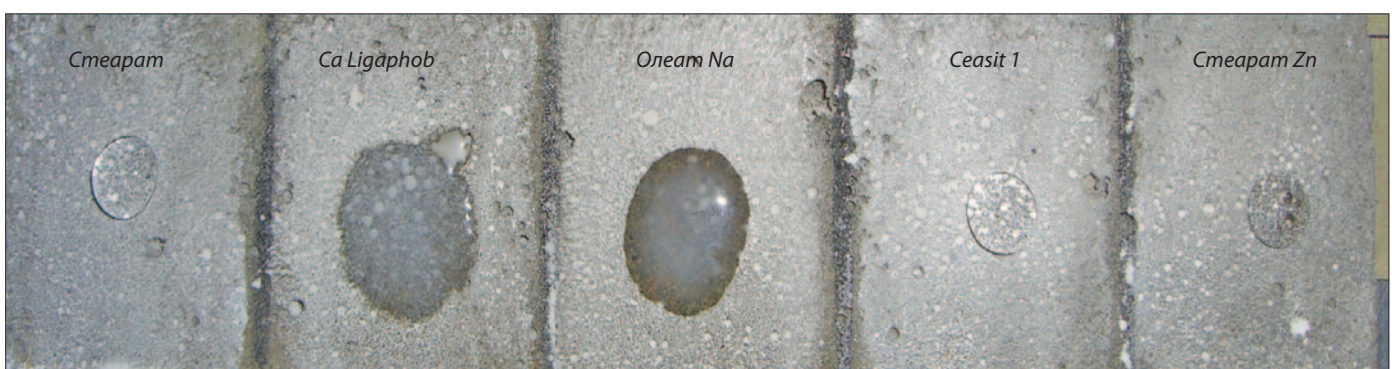
Фото 2. Поверхностная гидрофобизация цементно-песчаного композита
