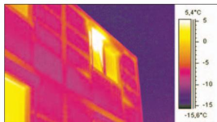
Тепловизоры эффективны при диагностике теплопотерь типовых многоквартирных домов
