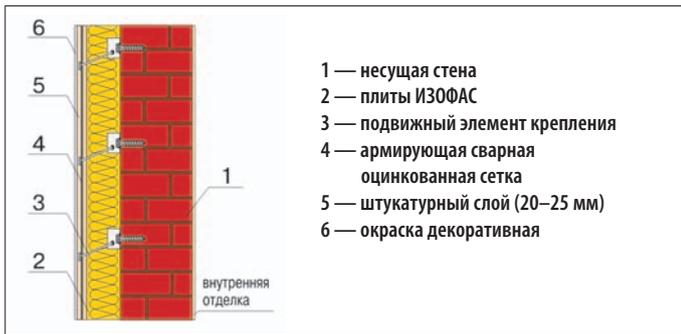
утепления любых типов здания. Теплоизоляционные плиты ИЗОФАС, производства ЗАО «ИЗОРОК», не горючи, паропроницаемы, обладают высокими прочностными характеристиками и идеально подходят для конструкций с декоративным штукатурным покрытием. Плиты ИЗОФАС крепятся к стене с помощью клея и дюбелей (в конструкциях с тонкослойным штукатурным покрытием) или специальными шарнирными крепежными элементами (в конструкциях с толстослойным штукатурным покрытием).
